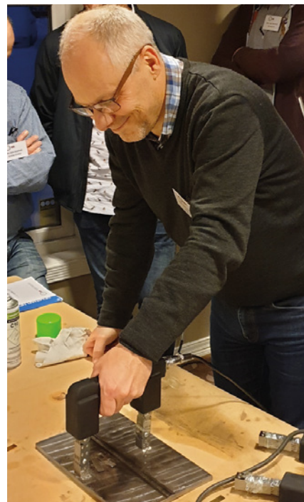
Geir Amund Indahl fra Vitec AS ville også prøve Magnetpulver testing med Yoke magnet. Det ble testet både for tilstrekkelig feltstyrke, feltretning og løftekraft etc.
